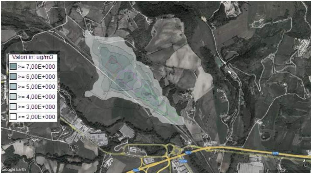
Figura 6-38 Concentrazioni di  $PM_{10}$  dovute alle emissioni dei mezzi d'opera per l'area di valutazione 2
