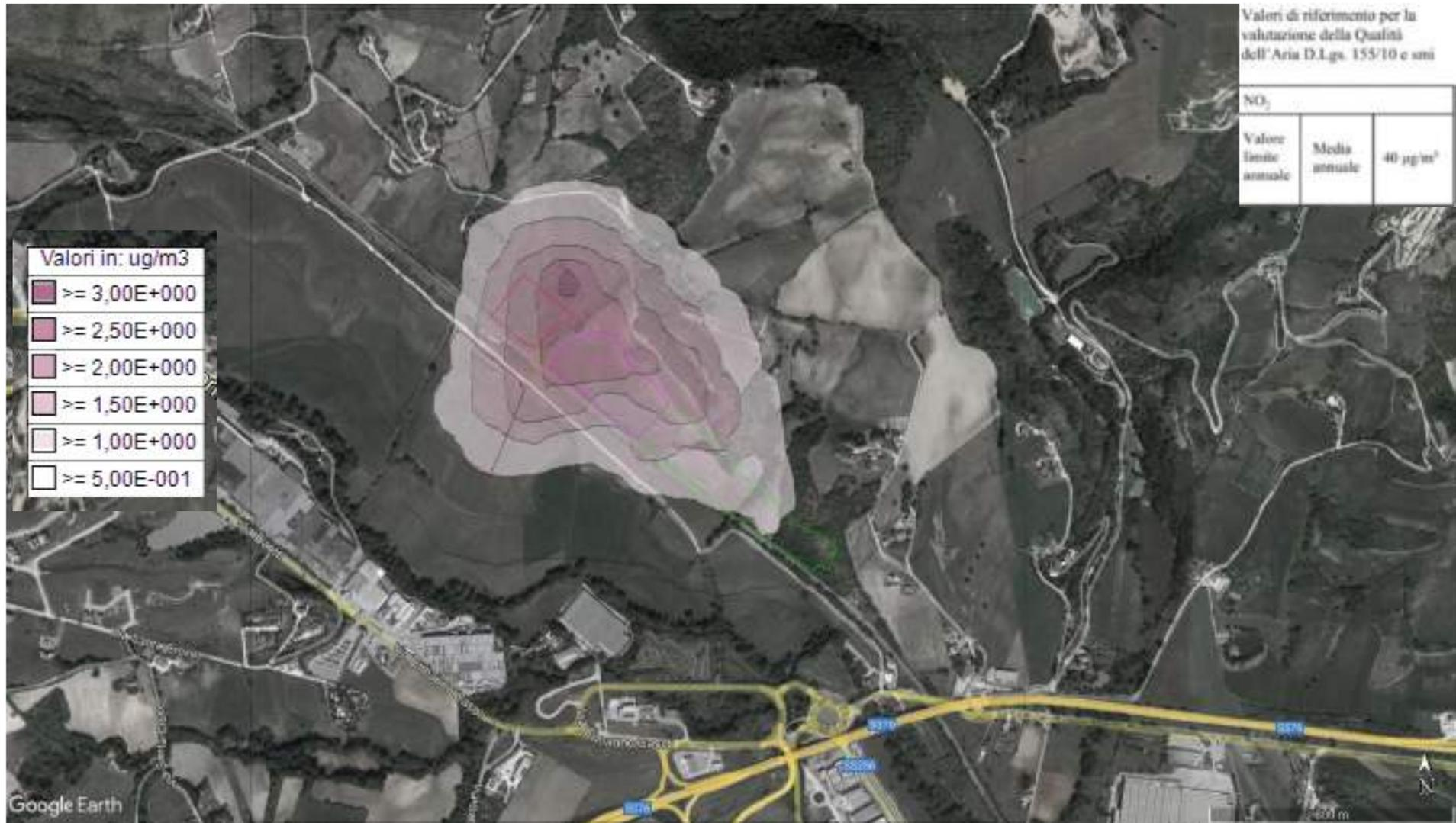
Concentrazioni di NO<sub>x</sub> dovute alle emissioni dei mezzi d'opera per l'area di valutazione 2
