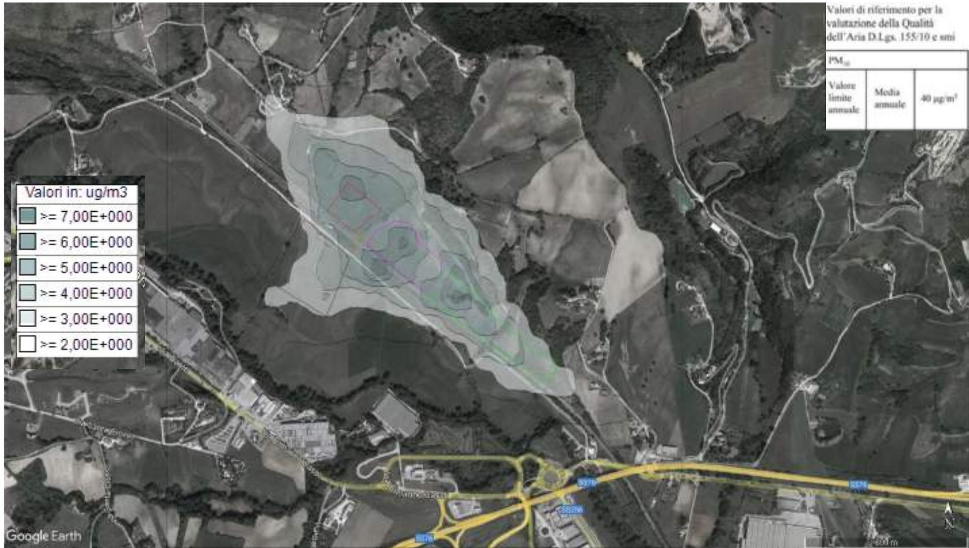
Concentrazioni di PM<sub>10</sub> dovute alle emissioni dei mezzi d'opera per l'area di valutazione 2
