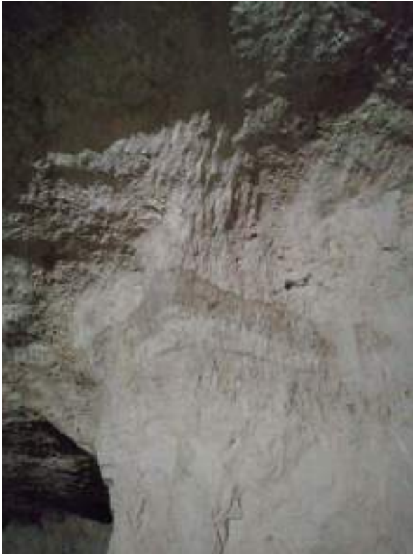
Foto 1- Foto 2: Situazione tipica dello stato di fratturazione degli affioramenti in sotterraneo. Le fratture sono limitate alla presenza di joint sub verticali di modesta persistenza (circa 1.5 m) ed alla presenza di superfici con direzione ortogonale all'andamento dei cameroni.
