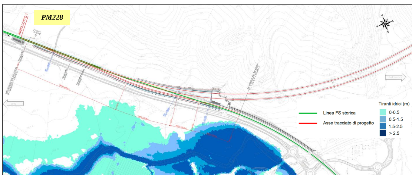
Fig. 6 – Modello numerico 2D del Fiume Esino: aree potenzialmente inondabili, Tr = 200 anni, post operam , in quel di PM228.
