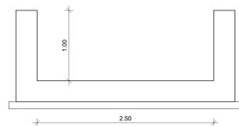
Sezione tombino idraulico di attraversamento
