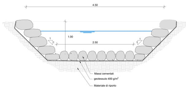
Riprofilatura alveo con canale rettangolare
